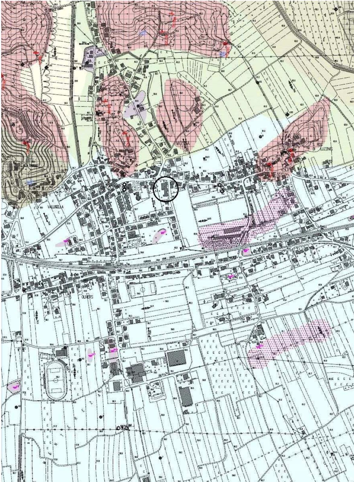
**Figura 5** - Estratto dalla “Carta litostratigrafica del sottosuolo, dell’intensità della suddivisione delle masse rocciose, delle caratteristiche geomeccaniche e geotecniche”; l’area ricade in zona di terre con strati di limo e/o argilla inferiori o uguali al 10% - scala originale 1:5.000
