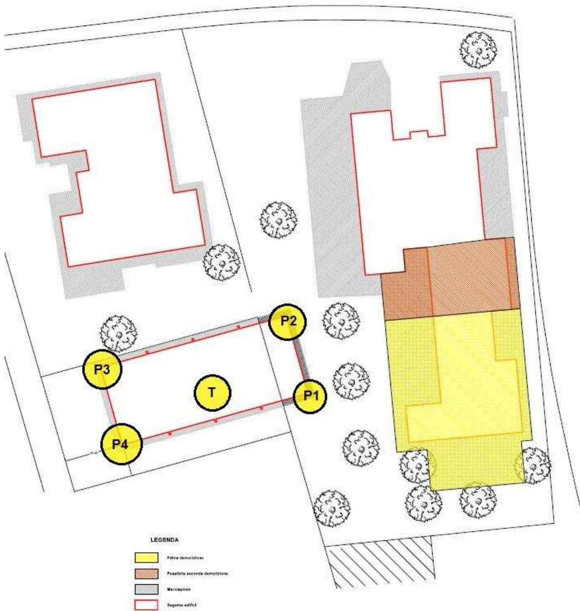
**Figura 3** - Planimetria di progetto con indicazione delle prove penetrometriche e sismica eseguite – fuori scala
