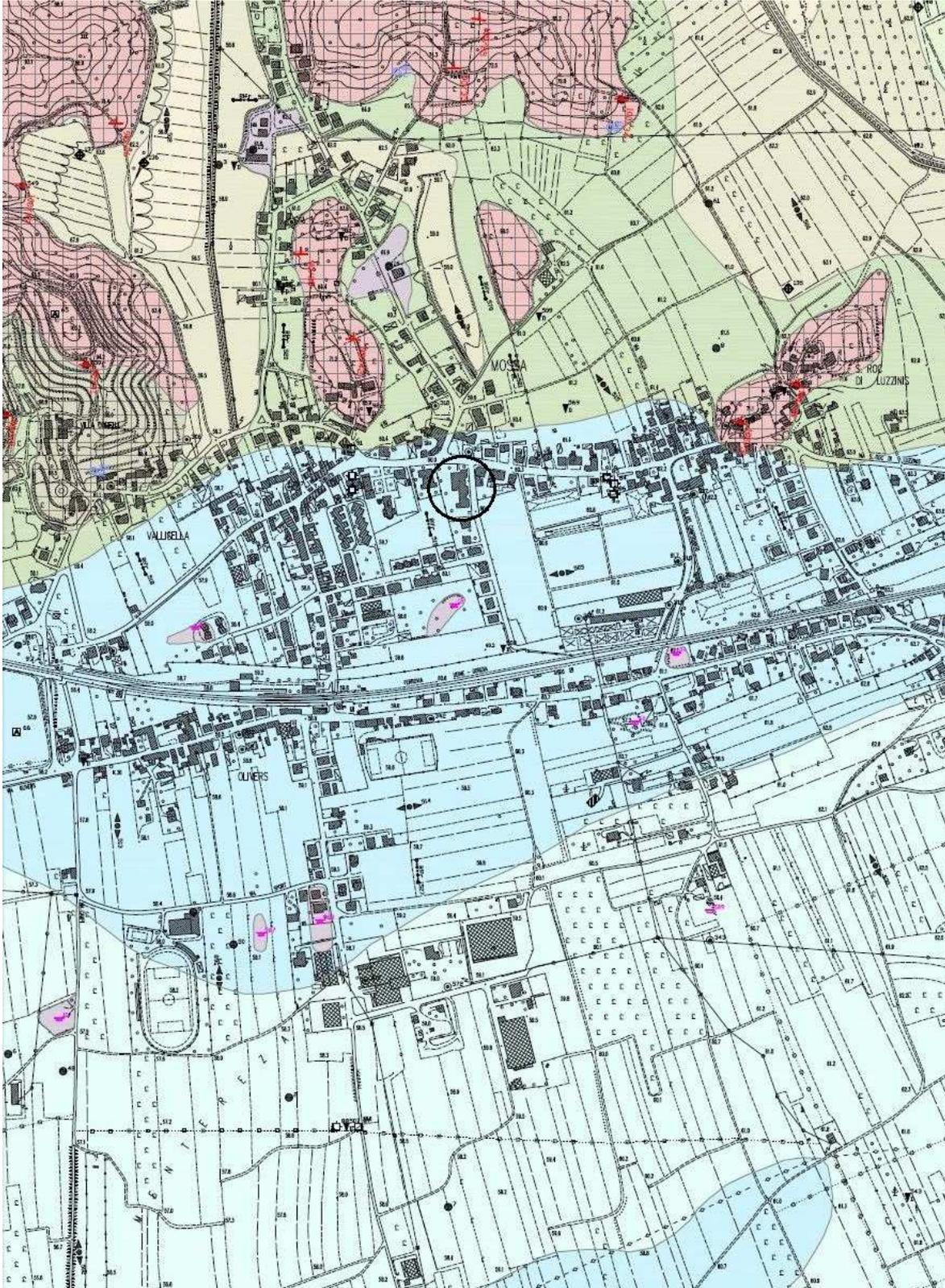
**Figura 6** - Estratto dalla “Carta litostratigrafica (formazionale), dell’intensità della suddivisione delle masse rocciose e strutturale” del Servizio Geologico Regionale; l’area ricade in zona GSM: sedimenti prevalentemente ghiaiosi con limi, argille e sabbie - scala originale 1:5.000
